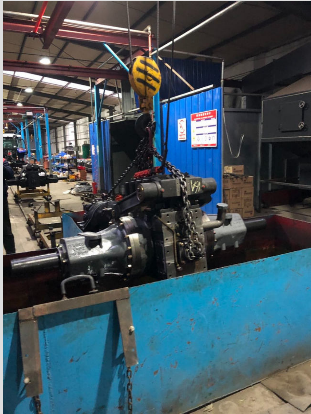
Prueba hermética de la caja de cambios
